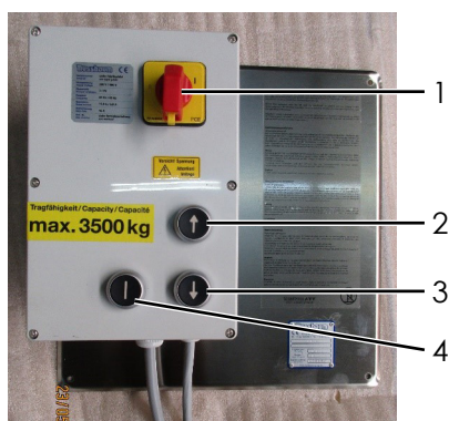
Elemento di comando con centralina idraulica interna e pulsante di arresto CE 001
