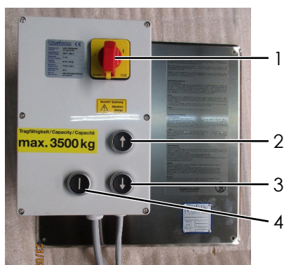
Élément de commande avec groupe hydraulique interne et touche Arrêt CE 001
