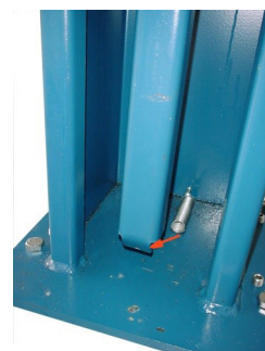
Figure 6 : accrocher les ressorts de traction aux crémaillères.
