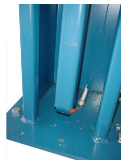
Fig. 6: Fissare le molle di tensione alle barre inserimento perni.
