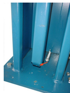
Bild 6: Zugfedern an den Klinkenleisten einhängen.
