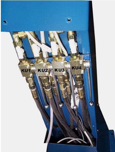
fig 2: robinets à boisseau spherique
