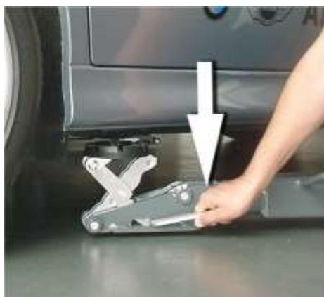
Figure 2 : Le cas échéant, positionner les plateaux porteurs sous les points de levage en appuyant sur le levier.
