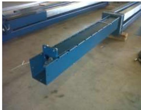
Fixer la rallonge à l'aide des longues vis après la mise en place de la tôle de tension (A).
