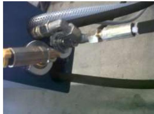
**Remplacer par les flexibles hydrauliques fournis**
