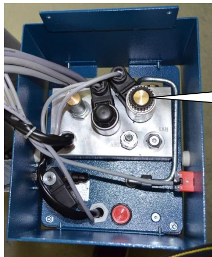
Figure 4 : Vis d'abaissement de secours sur le module
