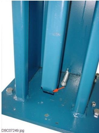
Figure 6 : accrocher les ressorts de traction aux crémaillères.
