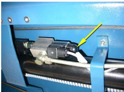
Bild 2: Doppelsitzventil mit Handbetätigung am Zylinder
