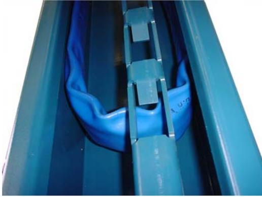
Avant la première mise en route du pont le tuyau de protection à l'intérieur de la colonne commande est à nettoyer et à graisser avec un huile pour éviter qu'il reste collé sur la colonne.
