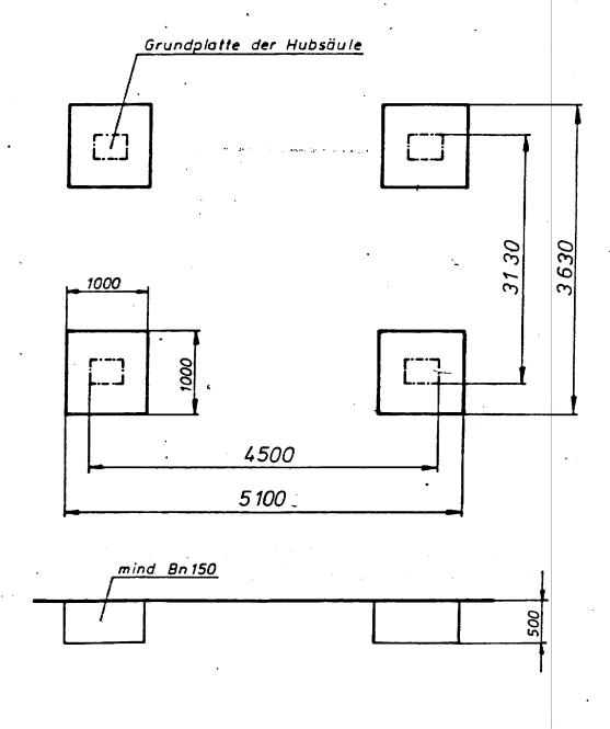
Der Boden soll auf der ganzen Fläche in der Waage liegen. Bei einer Stärke des Betonbodens von weniger als 150 mm müssen Fundamente gesetzt werden (siehe obige Zeichnung), ansonst können die Dübelbohrungen direkt in den Werkstattboden vorgenommen werden.
