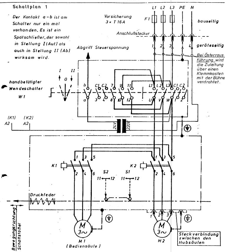
Netzanschluft 3~/N+PE 50Hz 380/220V
