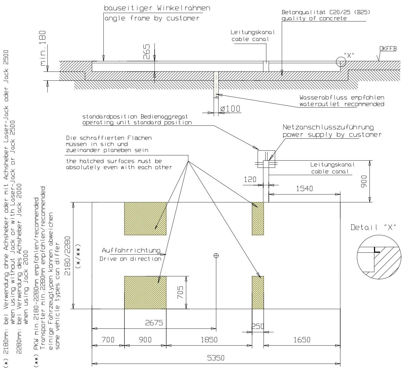
(\*) 2180mm: bei Verwendung ohne Achsheber oder mit Achsheber Laser-Jack oder Jack 2500
