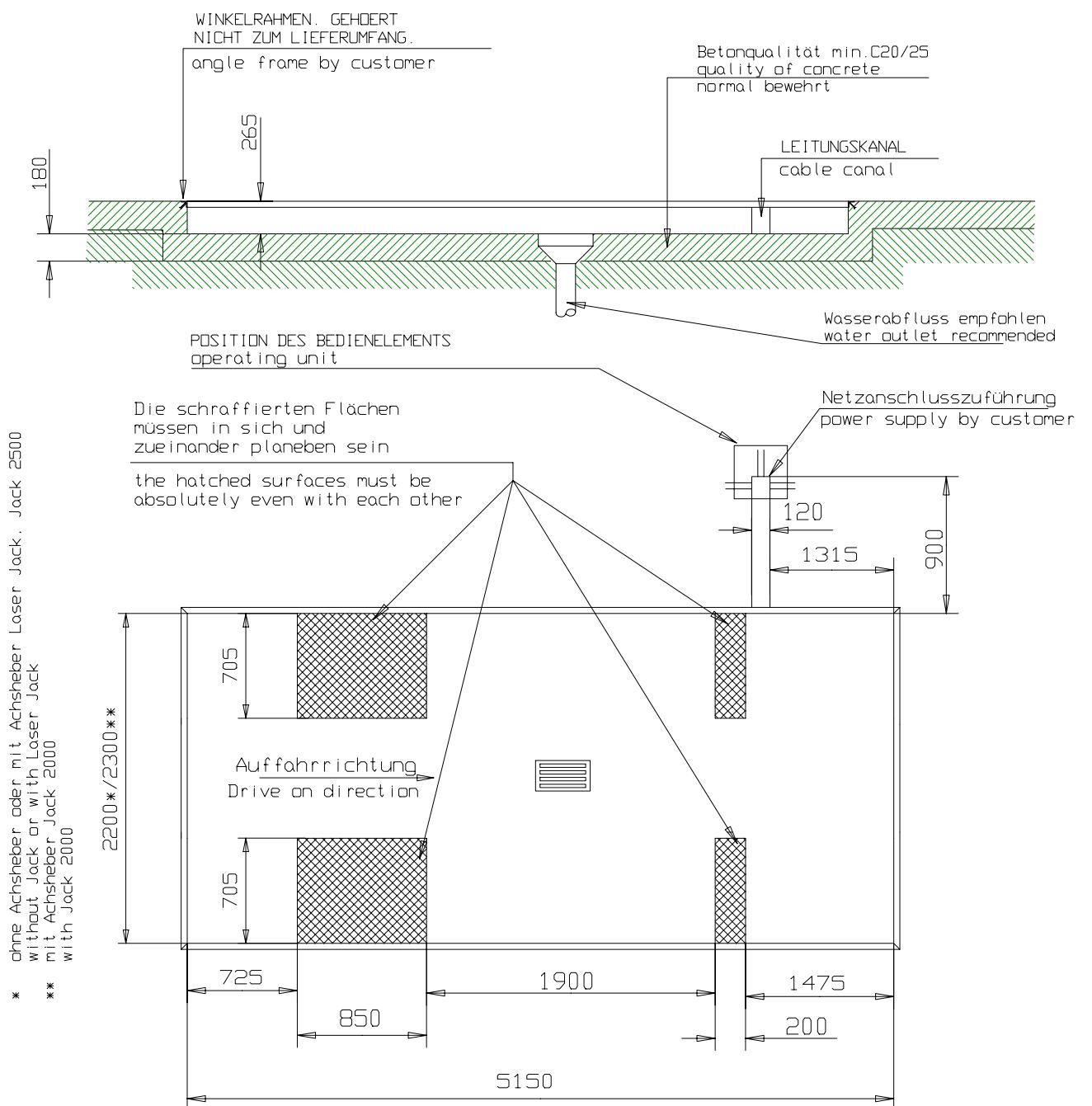
Achtung: Gilt nur für die Serienausführung mit Stellplatten und beidseitigen Auffahrklappen. Anstelle des Leitungskanals kann auch ein Leerrohr Ø 100 verlegt werden.
