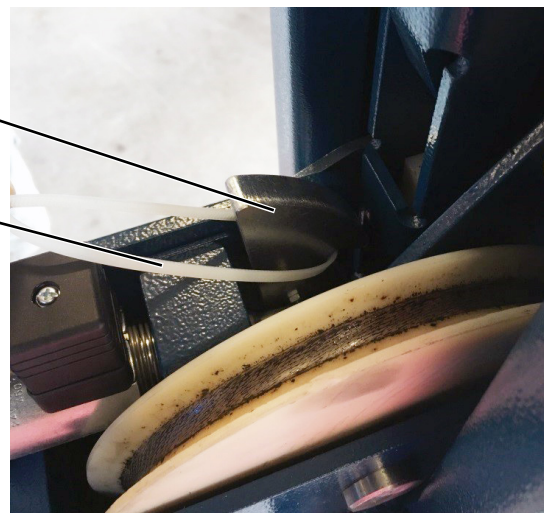
j Sicherheitsklinke i Kabelbinder
