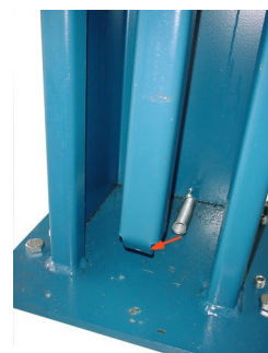
Figure 6 : accrocher les ressorts de traction aux crémaillères.
