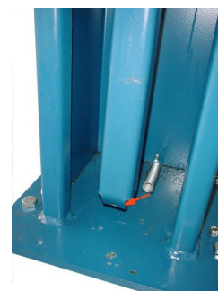
Bild 6: Zugfedern an den Klinkenleisten einhängen.
