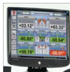
Contrôle du train avant
